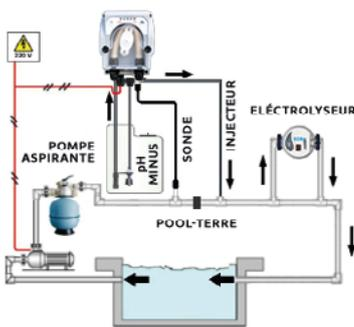
Die pH-Pumpe muss in den Wasserkreislauf des Schwimmbeckens eingebaut werden. Die pH sowie das Injektionssystem müssen vor dem Elektrolysegerät positioniert werden. Platzieren Sie die pH-Messsonde in der Nähe eines Pool-Erdbeckens.
