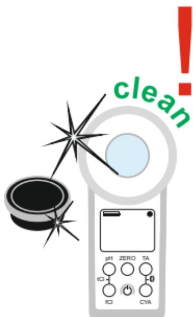
Es ist wichtig, das Gerät nach jeder Messung zu reinigen, um sämtliche Reagenzienrückstände zu entfernen!
