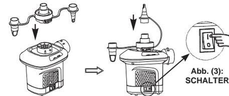
Abb. (4): ANSCHLIESSEN DER DÜSE
