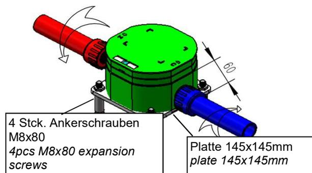
Verbinden Sie die Anschlüsse der Montagebox mit den entsprechenden Leitungen für Kalt- und Warmwasser. Dichtigkeitsprüfung nicht vergessen
