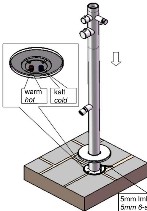
Setzen Sie das Unterteil der Dusche auf die Montagebox und verbinden Sie beide mit vier Schrauben. Beachten Sie bitte die Anordnung der Zuleitungen Kalt- und Warmwasser. Danach schieben Sie die Abdeckrosette nach unten über die Montageplattform
