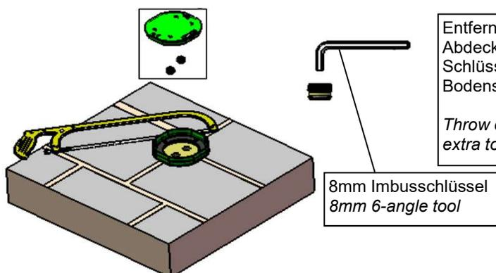
Entfernen Sie jetzt die Schutzabdeckungen der Montagebox, inkl. der Abdeckungen an den Wasseranschlüssen mit einem 8mm Imbus Schlüssel. Kürzen Sie die Montagebox auf die Endhöhe des fertigen Bodens.
