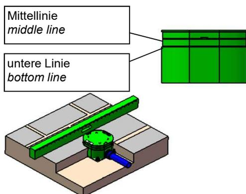
Vergewissern Sie sich, dass die Montagebox vertikal gerade und zentriert auf Sie ausgerichtet ist. Nun montieren Sie die Montagebox mit den vier Ankerschrauben M8. Bitte beachten Sie, dass der fertige Boden (Fliese oder ähnliches) höher als die Bodenlinie und niedriger als die Mittellinie der Montagebox sein muss.
