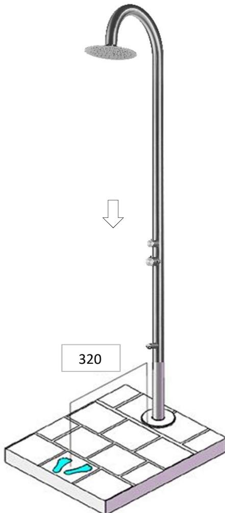
Verbinden Sie das Oberteil der Dusche mit dem Unterteil. Eine rechteckige Markierung hilft Ihnen bei der Ausrichtung. Fixieren Sie danach das Ober- und Unterteil der Dusche mit der Madenschraube. Danach schließen Sie die Handbrause an (falls vorhanden)
