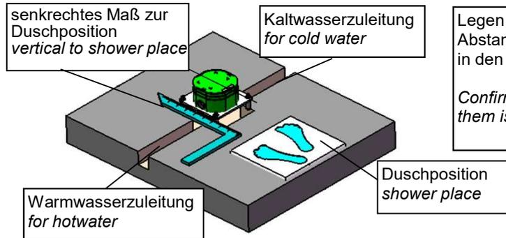
Legen Sie die Position der Montagebox fest. Beachten Sie bitte den Abstand zur Duschposition von 320mm. Danach wird die Montagebox in den Boden eingebracht (bitte entsprechendes Loch vorbereiten)
